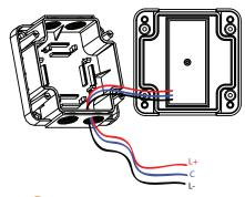
3 Encaixe a base e a tampa novamente e parafuse-as
